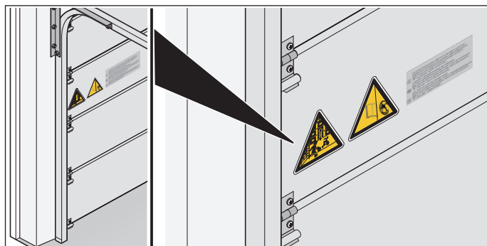
Abb. 1.2 Aufkleber am Torblatt anbringen
