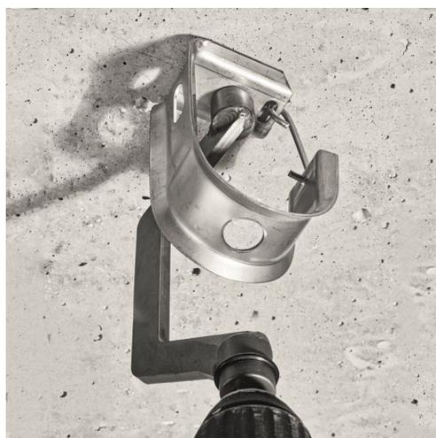
Einfache Montage! Mit dem Setzwerkzeug seitlich in den Metallsammelhalter einfahren, den MND Nageldübel mit dem Setzwerkzeug fixieren und einschlagen.
