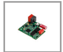
X.BE Elektronische Karte als Schnittstelle zwischen dem KNX- Kommunikationssystem und den Beninca- Automatiken.
